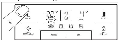
Для установки температуры нажмите на кнопку **REF SET** до появления нужного значения. Для ускоренного замораживания нажмите и удерживайте кнопку **REF SET**, пока не загорится индикатор «Супер». Для отмены режима просто снова нажмите на кнопку.
