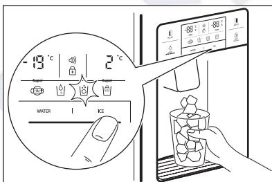
При очистке емкости для кубиков льда или после длительного ее неиспользования удалите кубики льда из емкости для их хранения и заблокируйте льдогенератор, нажав на кнопку ICE(«Лед») и удерживая ее 3 секунды. Высвешивается символ
