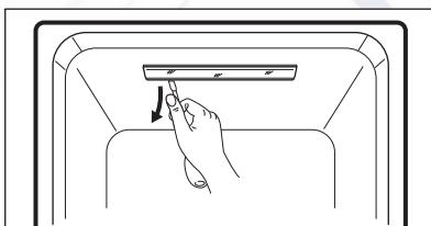
2. Separe la cubierta LED y afloje los 2 tornillos de fijación de la placa LED.
