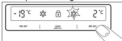
Para ajustar la temperatura pulse la tecla **REF. SET** hasta que aparezca la temperatura deseada.
