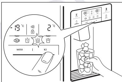
Cuando limpie el montaje de la caja de cubitos o no lo utilice durante mucho tiempo, quite los cubitos de la caja de almacenamiento de hielo y bloquee la fabricación de hielo pulsando el botón ICE durante 3 segundos. El icono se encenderá.
