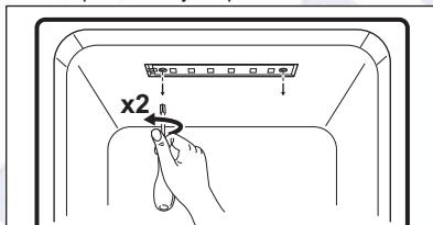
3. Izključite kable plošče s svetlečo diodo in zamenjajte svetlečo diodo.
