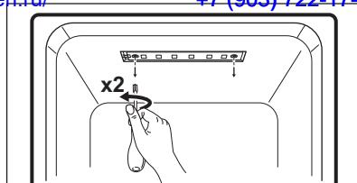
3. Desligue os fios da placa e substitua a iluminação LED.
