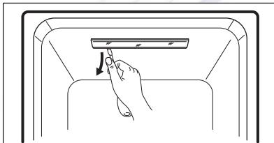
2. Снимите крышку светодиодного модуля и ослабьте 2 винта, крепящих плату светодиодов.
