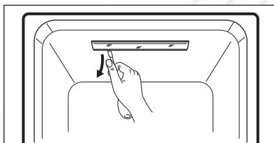
2. Ločite pokrov svetleče diode in popustite pritrdilna vijaka plošče s svetlečo diodo.
