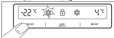
Para ajustar la temperatura pulse la tecla **FRZ. SET** hasta que aparezca la temperatura deseada.
