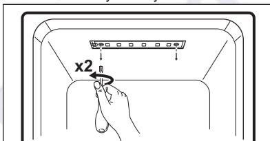
3. Odpojte zväzok káblov od dosky s diódami LED a vymenite svetlo LED.
