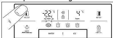
Para ajustar la temperatura pulse la tecla hasta que aparezca el valor deseado.
