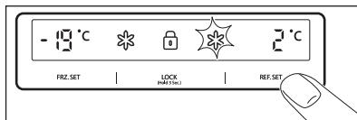
Za nastavitev temperature pritisnjite tipko **REF. SET** , dokler se ne prikaže želena temperatura.
