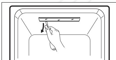
2. Zdjąć osłonę oświetlenia LED i odkręcić 2 wkręty mocujące płytę oświetlenia LED.
