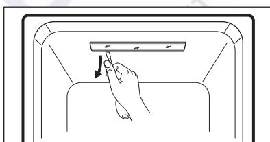
2. Separe a tampa da iluminação LED e desaperte os 2 parafusos de fixação da placa.
