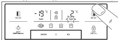
Для установки температуры нажмите на кнопку **REF SET** до появления нужного значения. Для ускоренного охлаждения нажмите и удерживайте кнопку **REF SET**, пока не загорится индикатор «Супер». Для отмены режима просто снова нажмите на кнопку.
