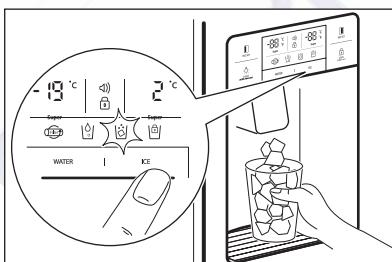
Pri čistení zásuvky na kocky ľadu alebo ak ste ju dlhší čas nepoužívali, vyberte kocky ľadu zo skladovacej zásuvky na ľad a zablokujte výrobník ľadu tak, že stlačte tlačidlo ICE a podržte ho 3 sekundy. Rozsvieti sa symbol
