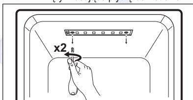
3. Odłączyć wiązkę przewodów od płytki oświetlenia LED i wymienić oświetlenie LED.
