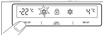
Za nastavitev temperature pritisnjite tipko **FRZ. SET** , dokler se ne prikaže želena temperatura.
